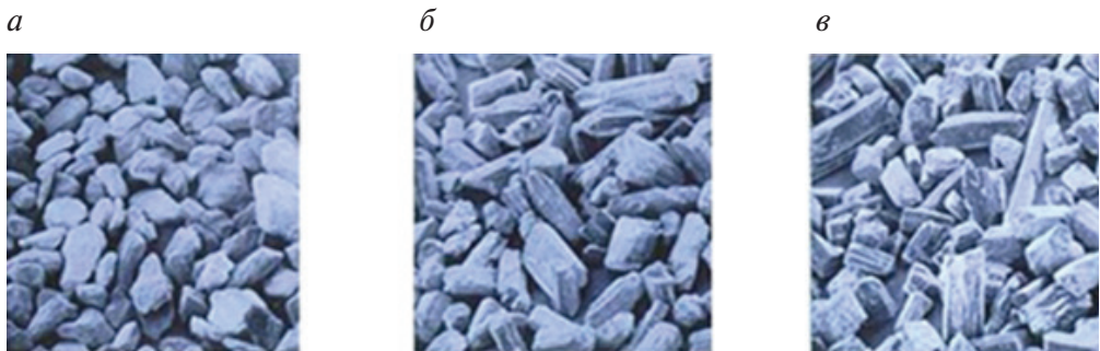
Рис. 5. Виды кристаллов полуводного сульфата кальция под электронным микроскопом:
